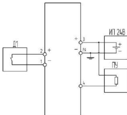
Рисунок 1 - Схема подключения датчика «сухой контакт»
